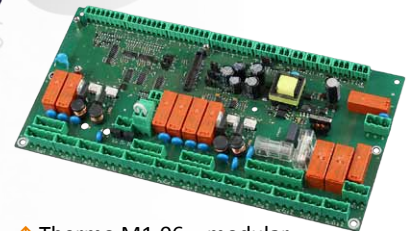
↑ Thermo M1.06 – modular erweiterbare Controller-I/O-Units
